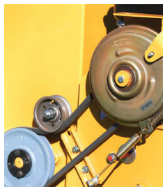
Remkoppeling: 5 seconden stop Embrayage à frein: arrêt 5
