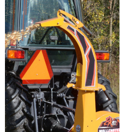
Verstelbare uitlaat - 270 of 360° Goulotte ajustable - 270 of 360°
