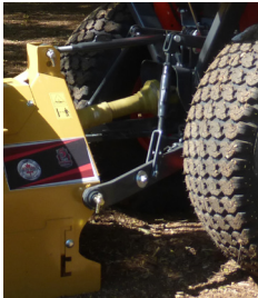
Universele 3de punts aansluiting Attelage universelle
