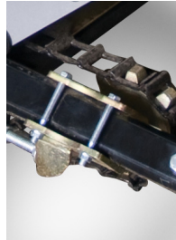
Kettingtensioning is eenvoudig aan te passen met kettingspanner Tension de chaîne facile à changer avec tenseur de chaîne
