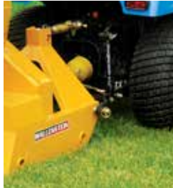
PTO-aandrijving met breekbout Cardan avec boulon de sécurité
