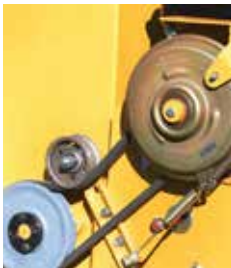
Remkoppeling: 5 seconden stop Embrayage à frein: arrêt 5 secondes
