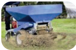
TOPDRESSER Épandage de compost, de sable, de terre, de caoutchouc ou d'un mélange
