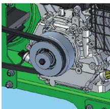
Les broyeurs propulsés par un moteur à essence sont tous équipés d'un embrayage centrifuge. L'embrayage garantit que le moteur n'est pas immédiatement chargé lors du démarrage de la machine. Cela augmente la durée de vie de la machine ainsi que le confort de l'utilisateur.
