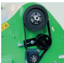
Toutes les tondeuses sont équipées d'un tendeur de courroie, facile à régler. Ceci est très accessible, de sorte que l'entretien puisse être effectué rapidement et efficacement.
