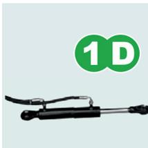
Kit pour déplacement latéral hydraulique FOX-S. Le tracteur nécessite 1 vanne à double effet.
