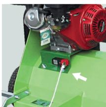
Interrupteur de sécurité avec cordon de traction pour actionner depuis votre véhicule.
