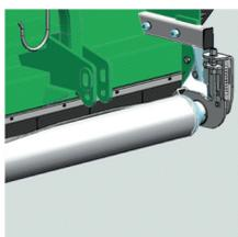
Toutes les tondeuses à fléaux avec ramassage sont équipées d'un rouleau presseur monté sur roulements. Cela permet de garantir la stabilité pendant la tonte et contribue à un motif de tonte parfait. Les modèles Koala et Panther peuvent également être équipés d'un rouleau avant. Cela rend la machine extrêmement adaptée aux terrains de sport et de golf.
