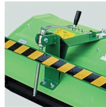
Poignée pour régler l'hauteur de coupe ou pour mettre la tondeuse en position de transport.
