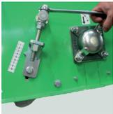
Le rouleau presseur est à régler facilement au millimètre, pour une tonte très précise.
