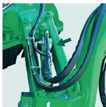
La machine est équipée de série d'un système hydraulique antichoc pour absorber d'éventuels chocs.
