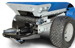
COMPOSTSTROOIER Mechanisme met 1 draaischijf
