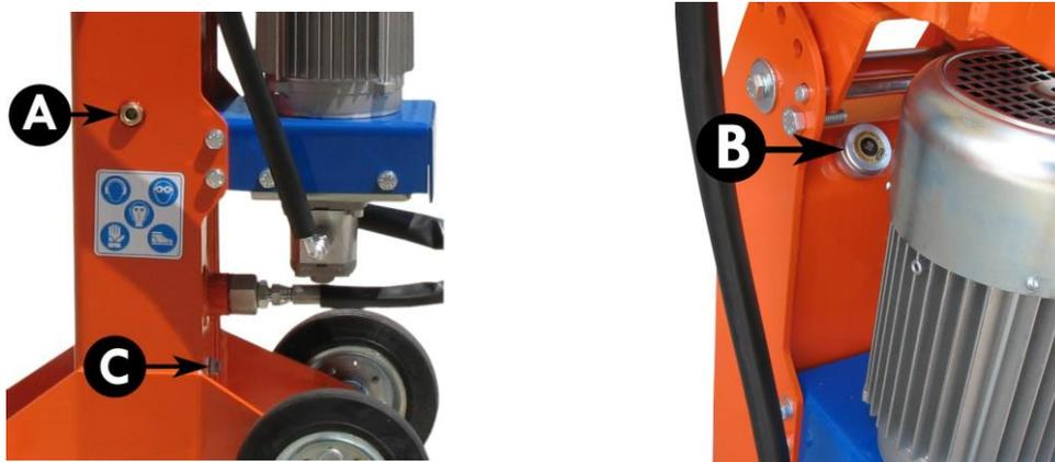
Pour vidanger l'huile usée, il faudra dévisser le bouchon (C) à la base du réservoir et la recueillir dans un conteneur à la capacité minimum de 10 litres,
