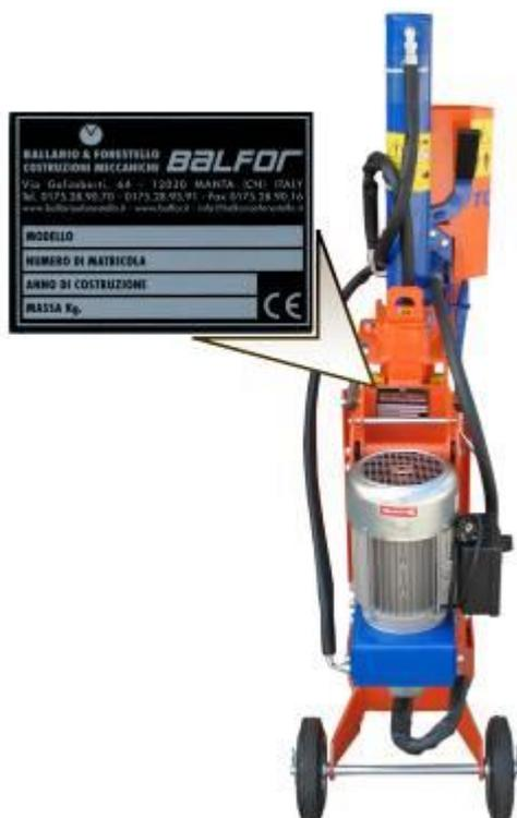
Une plaquette spécifiant la marque CE, les données du Constructeur, le modèle, le numéro de série, l'année de construction et le poids de la fendeuse est fixée sur le châssis de chaque machine.
