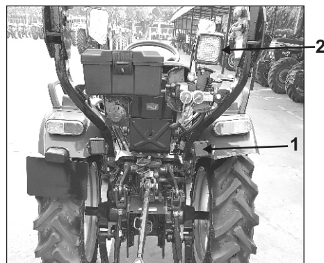
1. Rear reflectie licht 2. Ploeg licht
