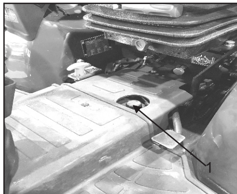
1. transmissie olie dipstick cum olie vullen haven.
